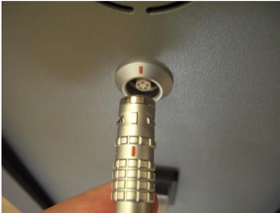
Figure 3-45. Aligned du trait rouge du connecteur du câble de la pièce à main d'extraction avec le trait rouge de la prise de branchement
