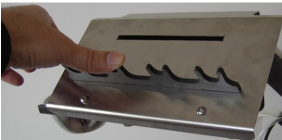
Figure 3-15. Insertion du support inférieur de pièce à main
