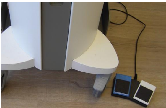
Figure 3-27. Interrupteur à pédale droit installé à droite du système
