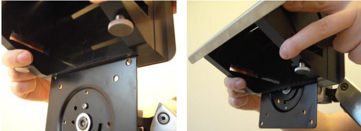
Figure 3-10. Insertion du plateau de pièce à main sur sa base
