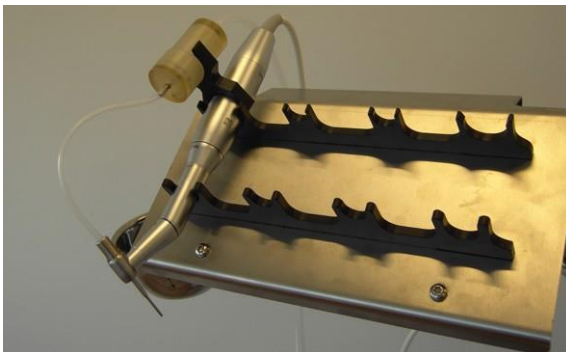
Figure 3-60. Placement de la pièce à main d'extraction sur le support de pièce à main
