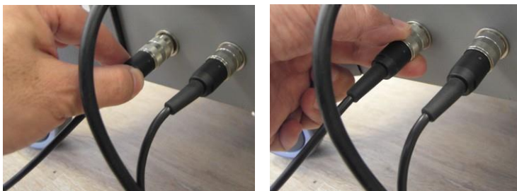
Figure 3-29. Raccordement du câble de l'interrupteur à pédale droite à son connecteur, situé à l'arrière du système
