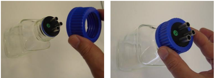
Figure 3-34. Fermeture du couvercle du bocal
