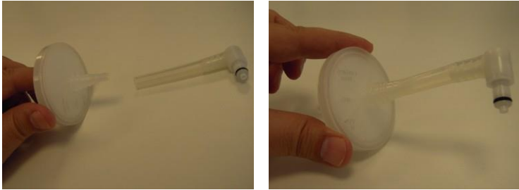
Figure 3-39. Raccordement du long tube et du raccord au port d'admission du filtre
