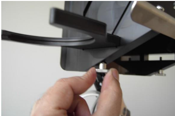
Figure 3-20. Serrage de la vis moletée du porte-gobelet
