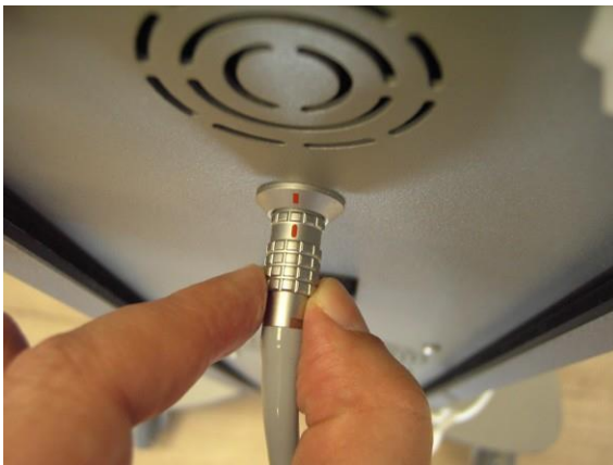
Figure 3-46. Branchement du connecteur du câble de la pièce à main
