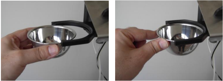
Figure 3-21. Insertion du gobelet dans le porte-gobelet
