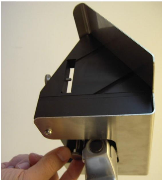
Figure 3-12. Serrage de la vis moletée du plateau de la pièce à main
