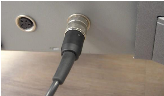
Figure 3-26. Câble de l'interrupteur à pédale gauche connecté
