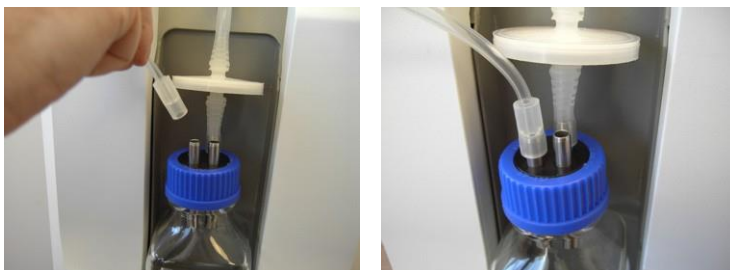
Figure 3-61. Raccordement du tuyau d'extraction au bocal
