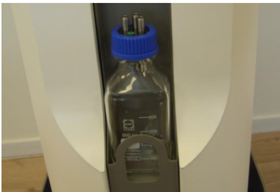
Figure 3-36. Bocal à déchets placé dans son logement, sur le système
