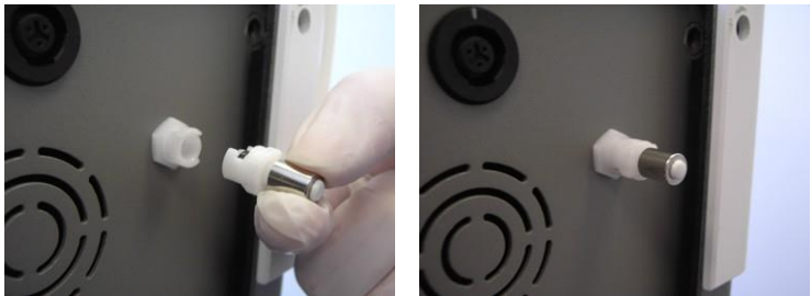
Figure 3-86. Raccordement du bouchon d'air Luer Lock au port de sortie d'air n°2 du système
