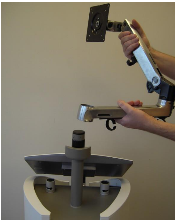
Figure 3-5. Positionnez le bras articulé sur son pivot sur le système
