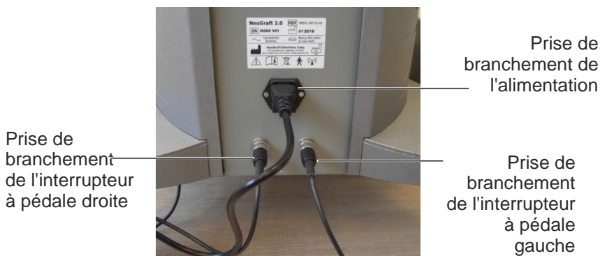
Figure 4-4. Composants du système (partie arrière inférieure)
