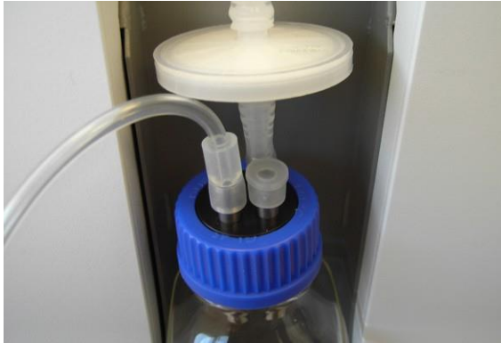
Figure 3-62. Bouchon en silicone placé sur le tube d'admission non utilisé du bocal à déchets
